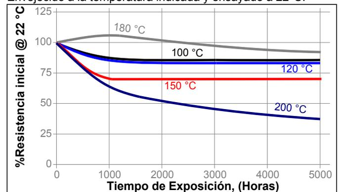
**Envejecimiento con Temperatura/ Resistencia al calor**
