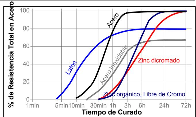
**Velocidad de Curado vs. Holgura de pegado** La velocidad de curado depende de la holgura de pegado. La holgura en las piezas roscadas depende del tipo, calidad y tamaño de rosca. La gráfica siguiente muestra la resistencia al corte desarrollada con el tiempo en perno y collarín de acero a diferentes holguras controladas y probadas de acuerdo a la norma ISO 10123.
